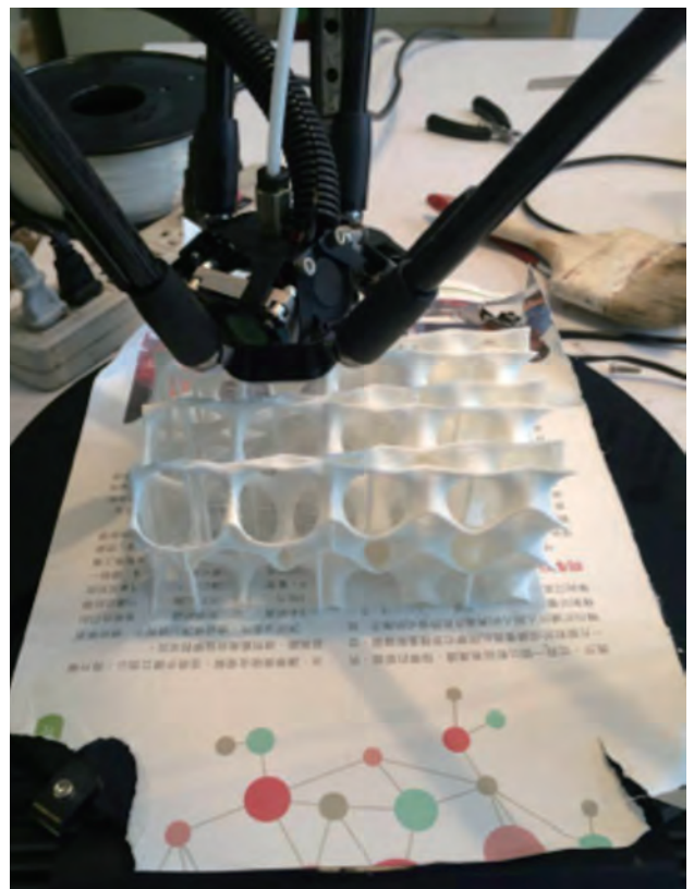
5.數位自造工坊3D列印機器測試製造骨骼結構系統
